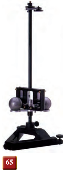
الشكل 3-6 تستعمل موازين كافندش الحديثة لقياس قوى الجذب بين جسمين.
