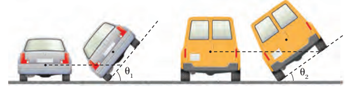
■ الشكل 11 - 4 مركز كتلة السيارة الصفراء أعلى من مركز كتلة السيارة الرمادية. فكلما كان مركز كتلة السيارة مرتفعًا احتجنا إلى ميل أقل لجعله يتحرك خارج القاعدة مسببًا انقلابها.
