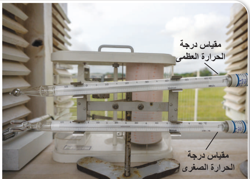
الشكل (14): مقياسا درجة الحرارة العظمى والصغرى. أتوقّع السبب في وضع مقياسي درجة الحرارة العظمى، ودرجة الحرارة الصغرى أفقيًا في كُشك الرصد الجوي.
