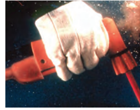
الشكل ٩ يحرق مشعل اللحام الهيدروجين والأكسجين لإنتاج حرارة أعلى من ٣٠٠٠°س، حتى أنها تستخدم تحت الماء. هذه نواتج هذا التفاعل الكيميائي.
