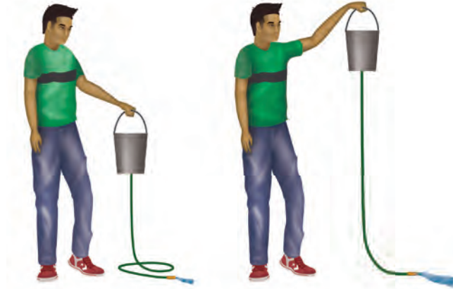
الشكل ٦ عند رفع الدلو إلى أعلى يزداد مقدار طاقة وضع الماء داخله، مما يُسبب زيادة سرعة تدفق الماء الخارج من الخرطوم.
