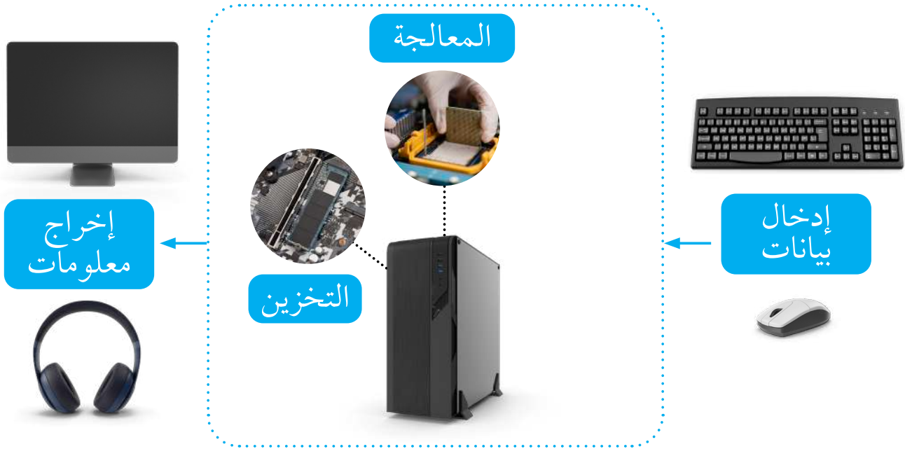
الشكل (1-1): رسمٌ توضيحيٌّ لمبدأ عمل جهاز الحاسوب.
